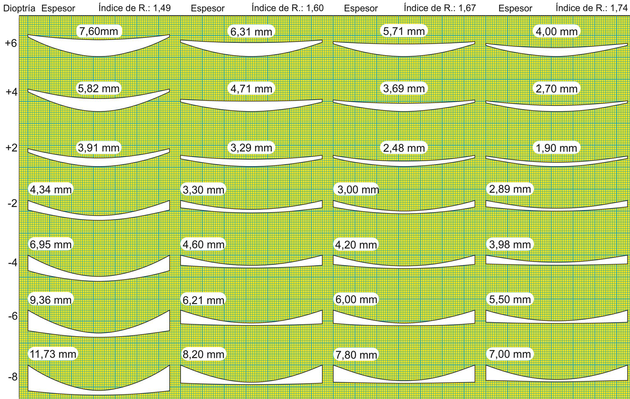
**Figura:** Dibujo esquemático que muestra el adelgazamiento de las lentes ópticas con diferentes índices de refracción de materias primas para distintas dioptrías. Tiene carácter orientativo; la forma de la lente puede variar según la prescripción y la elección de la montura. Inspirado en un catálogo de otro fabricante de lentes, fue dibujado por el Dr. Ercan Mensiz. Puede distribuirse libremente. [www.amansees.com](http://www.amansees.com)
