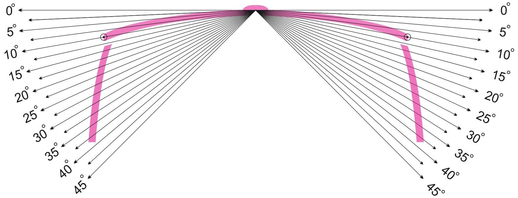
Escala de medición del ángulo de curvatura del marco
